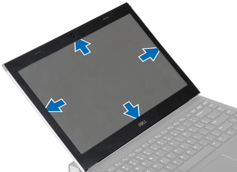
4. Heben Sie die Bildschirmblende an und entfernen Sie sie aus der Bildschirmbaugruppe.
