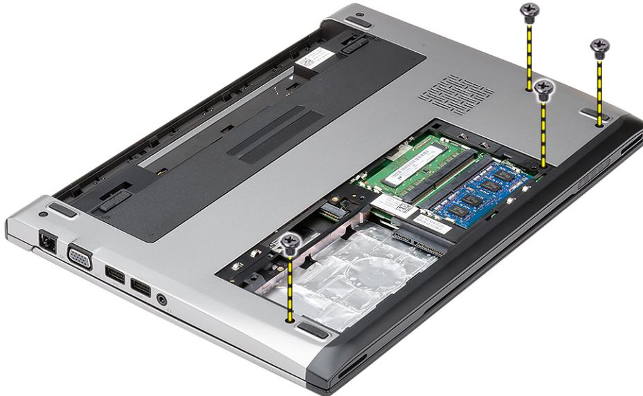
4. Entfernen Sie die Schrauben an der Handballenstütze.
