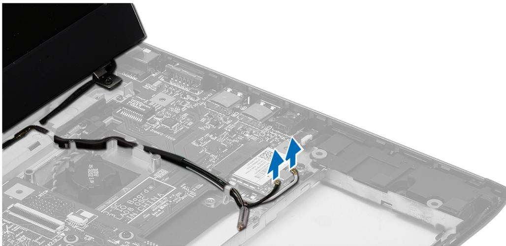
5. Trennen Sie das Bildschirmkabel vom Computer und lösen Sie es aus der Kabelführung.
