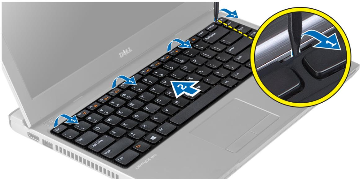
4. Schwenken Sie die Tastatur nach vorn und legen Sie sie auf der Handballenstütze ab.
